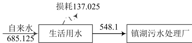
图 5-3 本项目水平衡图 (单位: t/a)
