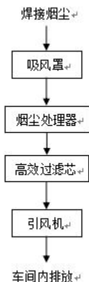
图 6.1-8 焊接烟尘处理工艺流程
