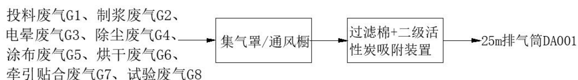
图 4-1 废气处理工艺流程图
