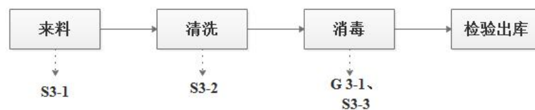
图2-4 清洗消毒工艺流程图
