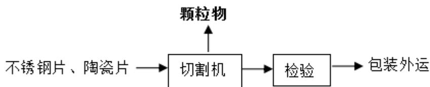
图 1-3 精密金属与非金属零件、陶瓷激光切割及钻孔生产流程图
