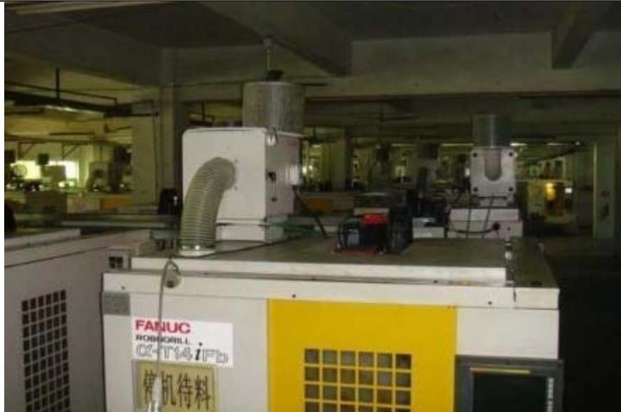
图 7-2 油烟过滤装置（示例）
