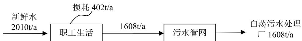
图 5-2 项目水平衡图
