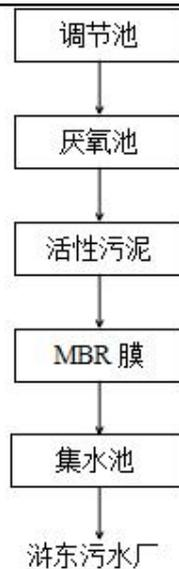
图 4-2 厂区污水处理设施工艺流程图
