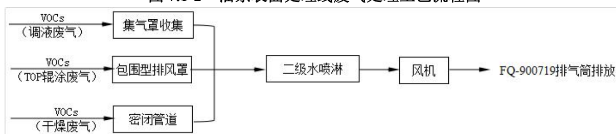
图 7.1-3 水系表面处理线废气处理工艺流程图
